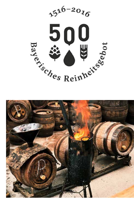
Die Handwerkskunst des Pichers: Holzfässer wurden mit Foch bearbeitet, um eine vollständige Dichtung zu erreichen.
